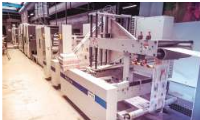
La ligne d'impression (une rotative Kodak Prosper 6000C cadencée à 300 mètres/minute) + finition (une FoldLine Manroland) s'étend sur 60 mètres en longueur.
